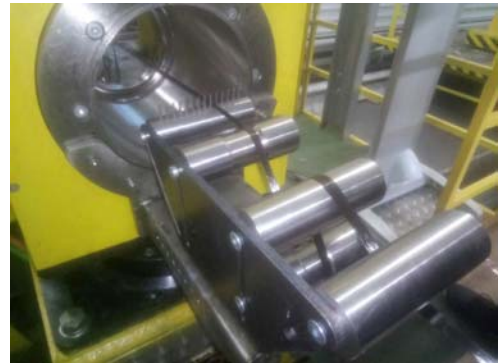
Рисунок 2 – Кінематична схема і розподіл стрічки в процесі проходження через спеціальне пристосування
